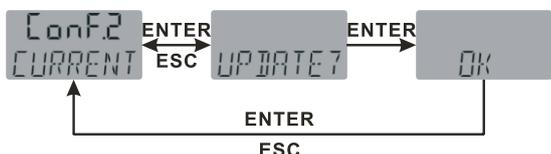
设置电流输出，进入“Conf.2 CURRENT”菜单，接到“UPDATE?”请求后，按ENTER键，显示“OK”，参数设置成功。仪表在出厂时就设置为该状态。
